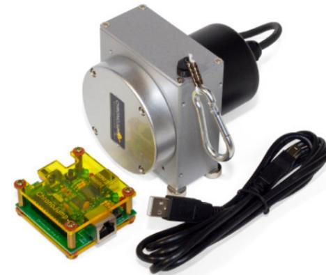
[Encoder lineal, Chronopic, cables y bolsa de transporte] Dispositivo que mide el desplazamiento lineal del ejercicio efectuado, ofreciendo datos de Potencia, Velocidad y Fuerza [todas ellas en fase propulsiva].
